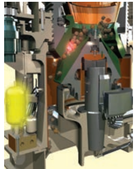
Nuevo diseño del dispositivo de protección anti-intrituras.
